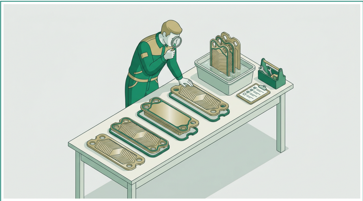
Осмотр пластин теплообменника в ходе плановой ревизии
